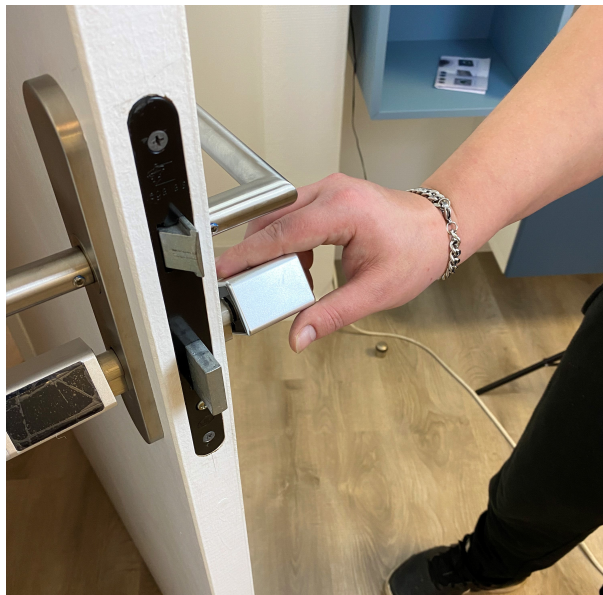
Vérifier le bon fonctionnement de la mollette Porte ouverte puis porte fermée.
